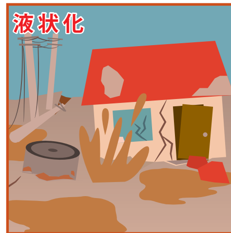
地震の揺れにより液状化が起こり、マンホールが浮き上がったり、建物の倒壊や道路の陥没が発生します。
