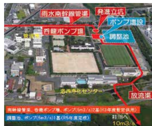
▲整備を進めている南幹線(呑龍ポンプ場)
