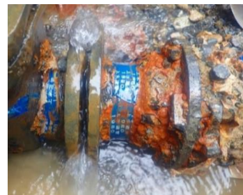
老朽化による漏水
