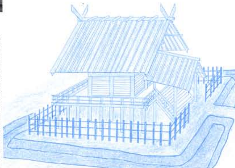
〔祭殿の推定復元図〕四方に縁を備えており、構造的に出雲大社の本殿と類似している
