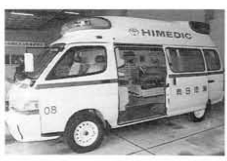
この高規格救急車は、従来の救急車より室内が一回り大きく、左右にスライド可能な防振ストレッチャー(担架)を装備し、高度な応急処置が行えるスペースを確保しています。
