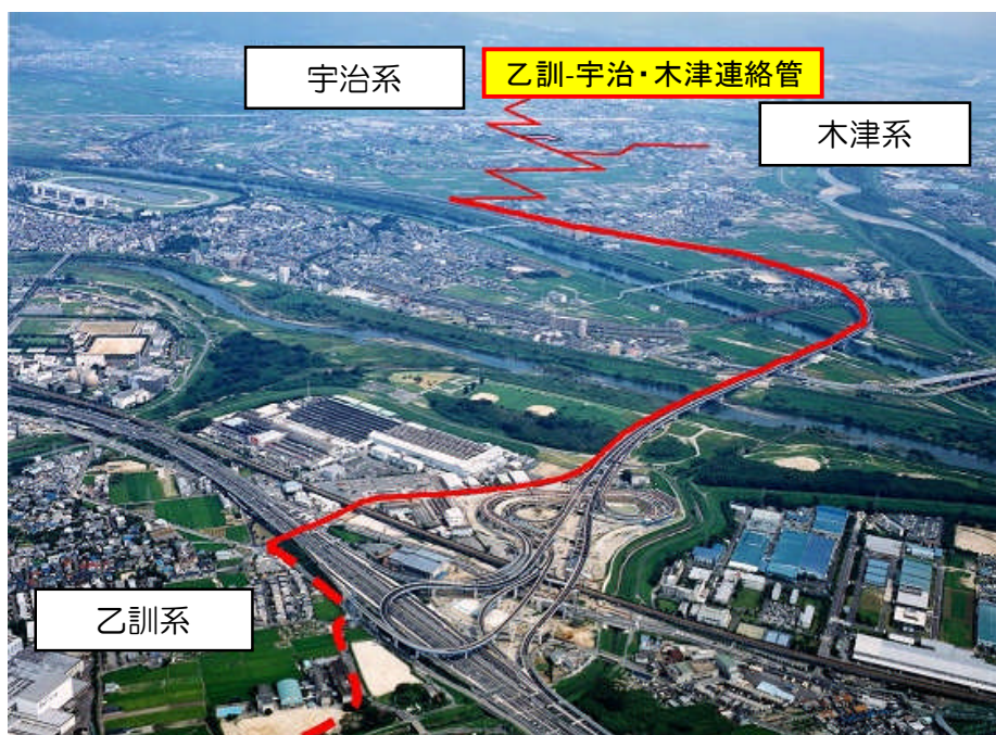
図12 京都府営水道3浄水場の接続（京都府資料より）
