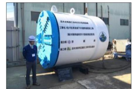
▲推進工法で使用する掘進機
