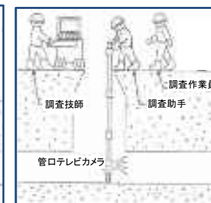
管口テレビカメラ調査概要図
