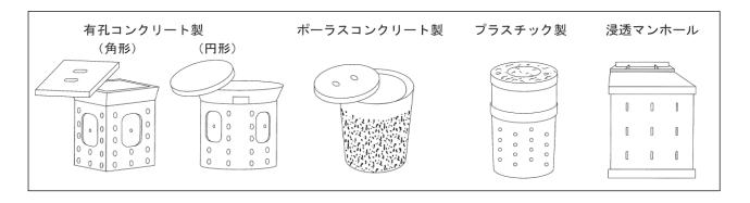
図3-15 浸透ますの種類と構造
