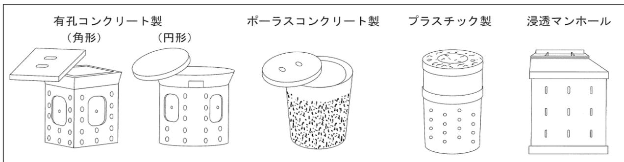
図3-15 浸透ますの種類と構造
