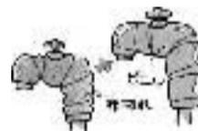
図のように、保温材(ポリエチレン保温筒、毛布や厚手の布でもよい)を取りつけ、これらが濡れないように上からビニルテープなどで巻いてください。
